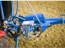
Horizontale Verstellung des Düsenaustritt. Durch einen zusätzlich Hydraulischen Zylinder montiert im Führungsarm, ist es möglich den Düsenlauf um ca. 1 mtr. (links/rechts) durch die horizontale Einstellung des Führungsarm zu verstellen. Hierdurch ist es nicht mehr nötig die Dränageausläufe exakt anzufahren.
